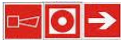
Кнопка включения установок пожарной сигнализации и оповещателей направо
